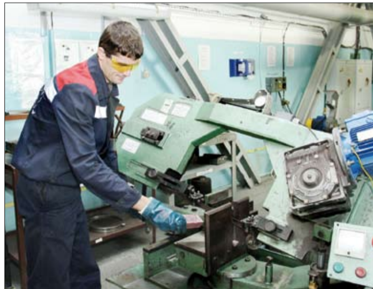
Контролёр продукции цветной металлургии 5 разряда Андрей Кузнецов готовит пробу анодов медных. Он получил пробный слиток, из него вырезал несколько пластинок. Сейчас на ленточнопильном станке он должен эти пластинки распилить на квадраты, которые затем исследуют в центральной лаборатории на содержание кислорода.
